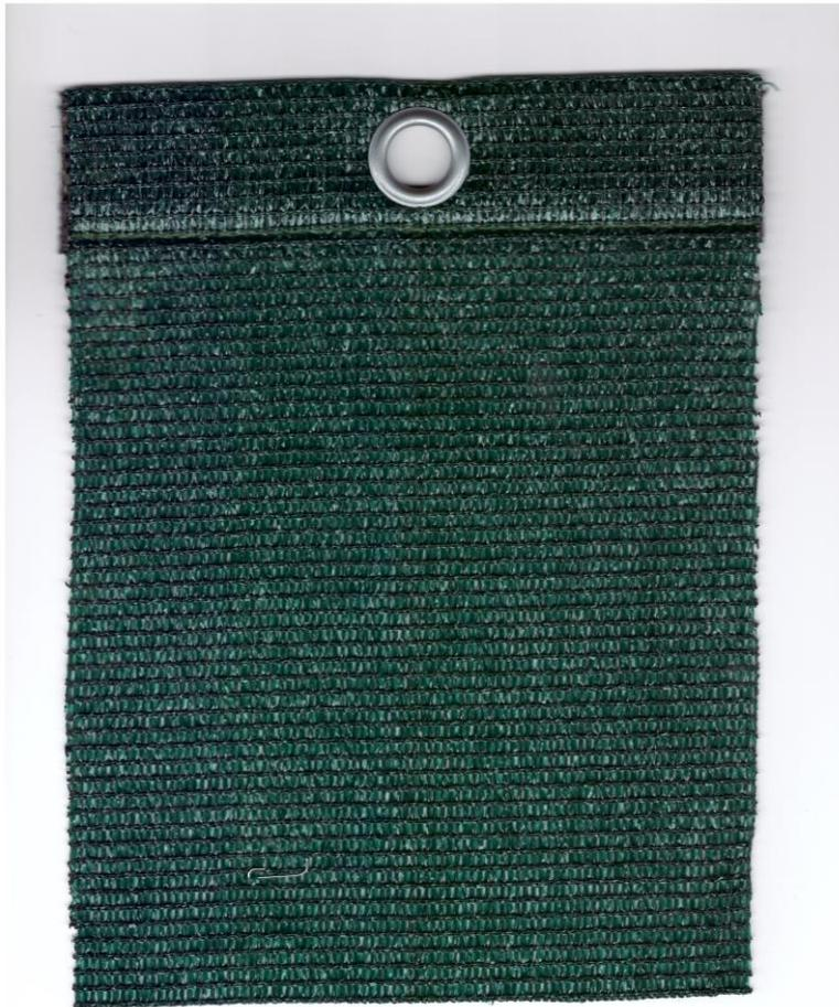
*Bild 6: Untersuchtes Kunststoffgewebe, Lieferant Fa. evia Verkehrstechnik GmbH/ACCURA NTV KG
